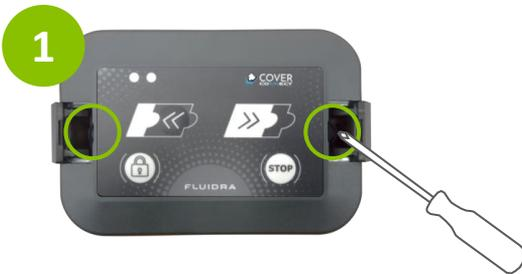
2 Attention à la limande du clavier lors de l'ouverture du boîtier et du remplacement de la batterie.
