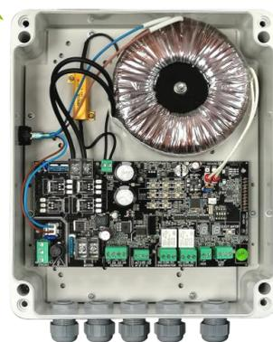
Récepteur radio intégré dans le coffret.
